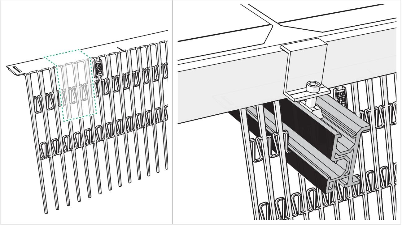
**10** Fijar las tiras BirdBlocker a los perfiles de los paneles solares.
