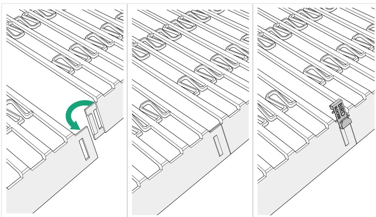
**9** ¿Hay una ruptura en el perfil? Entonces corte un hueco en la franja. Asegúrese de que el espacio bajo el panel solar esté bien cerrado por el BirdBlocker.
